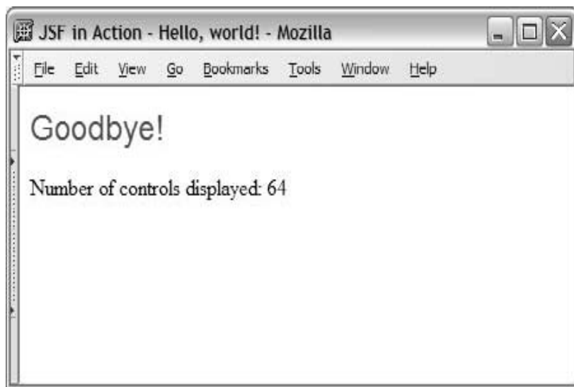
图 1.11 点击 Goodbye 按钮之后的 Hello, world! 应用。注意 JavaBean 属性，它与第一个页面中的文本字段保持同步，也被显示在此页面中。
